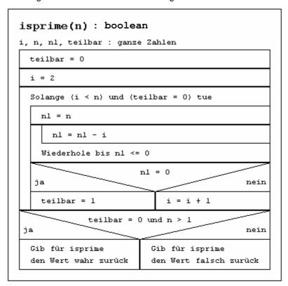
2) Für die Arbeit mit Brüchen ist z. B. für das Kürzen die Bestimmung des kgV oder des ggT notwendig. Das Struktogramm verdeutlicht eine Berechnungsidee:
